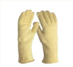
GANTS EN KEVLAR® SOUPLE DOUBLÉS LAINE SOUPLE Manipulation de pièces n'excédant pas 250 °C pendant 19 sec. Très résistants à la déchirure. Tissu Kevlar® para-aramide, doublure laine, couture Kevlar®. L 380 mm - 5 doigts - Taille 11
